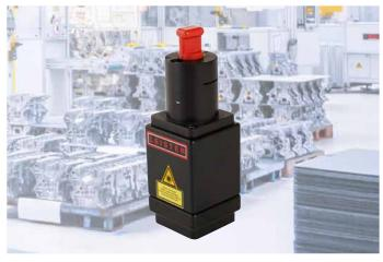
El rayo láser puede ser moldeado individualmente con el DOE Optic. La óptica de formación de rayos cambia la forma de un rayo láser puntual. También son fácilmente reemplazables a través del sistema de cajones. Se pueden generar geometrías para la soldadura simultánea, así como distribuciones de densidad de potencia que optimicen la entrada de calor en el plástico durante la soldadura de contorno. Estos sistemas ópticos se usan a menudo con láseres de fibra para ajustar la radiación al proceso.
