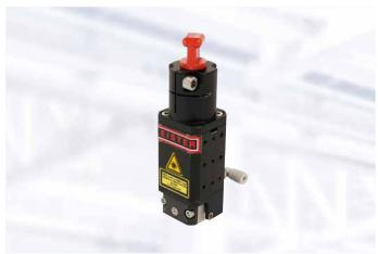
El Roller Optic no requiere ninguna tecnología de sujeción adicional. Con el Roller Optic un rayo láser lineal es guiado a través de un rodillo de vidrio, que es tanto la herramienta de presión como el último elemento óptico. El rodillo, que se apoya en dos lados, puede producir un ancho de costura de soldadura de unos 3 – 6.7 mm. Debido al cojinete de péndulo del rodillo, se pueden compensar pequeñas irregularidades en la dirección axial.
