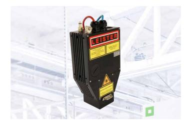
El LineBeam es la fuente de haz ideal para la soldadura de máscaras. Genera una línea con una distribución de densidad de potencia casi constante, lo que resulta en un patrón de soldadura consistente. El LineBeam es un sistema compacto que consiste en un láser de diodo y una óptica acoplada directamente. Los componentes ópticos del sistema pueden ajustarse a diferentes longitudes de línea.
