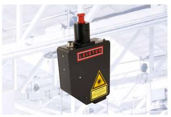
El Spot Optic enfoca el rayo láser a un punto y se utiliza principalmente para la soldadura de contorno. Las longitudes focales de las lentes de enfoque utilizadas determinan el diámetro del punto, que a su vez determina el ancho del cordón de soldadura. Por lo tanto, el rayo láser puede adaptarse a las necesidades individuales de la soldadura de plásticos mediante la sustitución de los componentes ópticos.
