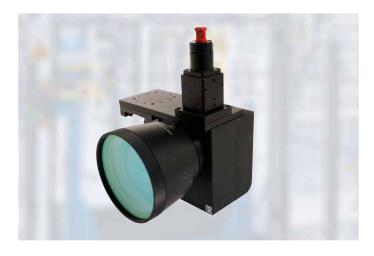
El Scanner Optic se caracteriza por la opción integrada de movimiento y se utiliza principalmente para la soldadura casi simultánea. Dos espejos móviles guían un rayo láser puntual a lo largo de un contorno programado. El tamaño del campo de trabajo puede ser ajustado por diferentes lentes de enfoque. Como todos los componentes ópticos, el Scanner Optic puede ser instalado en todos los sistemas de soldadura láser de Novolas<sup>TM</sup>.
