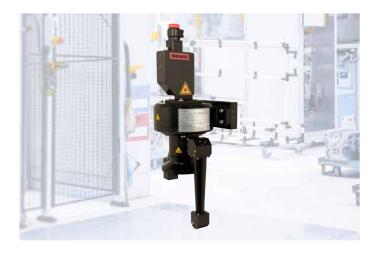
El Rotation Optic se utiliza para la soldadura secuencial de componentes simétricos de rotación. Funciona exclusivamente con un láser de fibra cuyo rayo láser se puede ajustar en diferentes diámetros mediante un DOE en forma de M. Un motor eléctrico síncrono con eje hueco y sistema de medición de posición incremental está integrado en la óptica y mueve un brazo en voladizo (rotor) alrededor del componente. El rayo láser es desviado hacia el centro por un espejo ajustable en el extremo del rotor.
