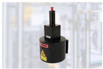
Con el Radial Optic, la soldadura láser sin rotación es posible sin tecnología de sujeción adicional. La soldadura radial es adecuada para los componentes simétricos de rotación que son difíciles de rotar por sí mismos. La radiación láser es desviada sobre la circunferencia de los componentes por un espejo cónico. Esto permite soldar simultáneamente componentes con un diámetro de hasta Ø 68 mm alto rendimiento y ciclos cortos.
