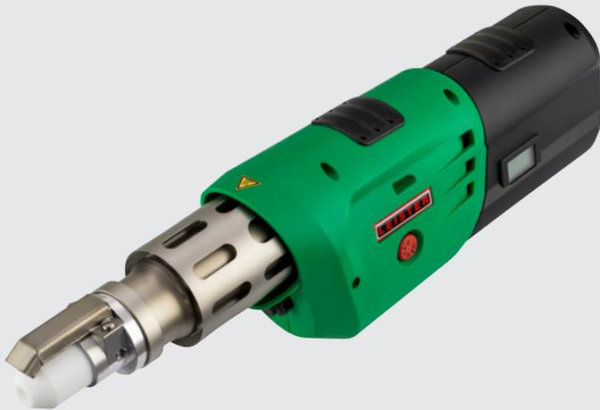
El extrusor FUSION 1 es particularmente fácil de manejar. La toma de la varilla de doble cara y la zapata de soldadura giratoria garantizan la máxima flexibilidad de la soldadura. Es adecuado para reparaciones de plástico, así como para la construcción de tuberías y contenedores.
